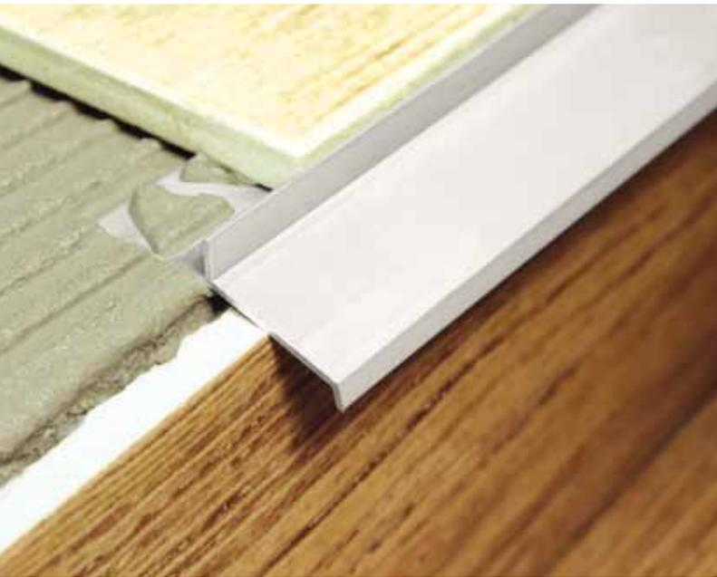
Das *VI-pulpitum* Profil ist für den Abschluss von Wasserabflüssen an Wannenträndern und Terrassen geeignet. Dank seiner Form leitet es das vom Belag abfließende Wasser zu 100% ab, so dass kein Wasser unter den Belag gelangt. Das Profil ist eine saubere, einfache und elegante Lösung für die Abschluss des Belags und den Schutz vor Wittereinflüssen.
